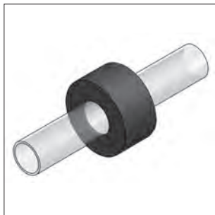
Dämmschale schließen und Überlappung andrücken.*
