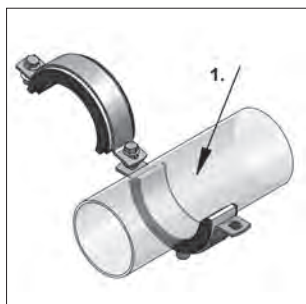
Rohr in der Kälteschelle positionieren.
