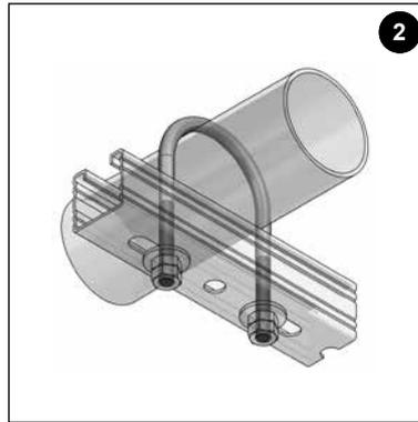
1. Rundstahlbügel über das Rohr schieben und Rundstahlbügel in das Befestigungsteil einstecken.
