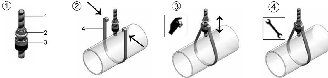
1. Gewindestange (1) montieren (z. B. im Dübel). Flanschnutter (2) auf Gewindestange (1) aufschrauben. Schlaufentopf (3), Zuordnung siehe neben stehende Tabelle, von unten auf Gewindestange (1) schrauben.
