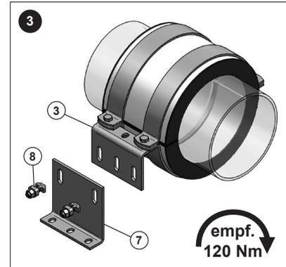
3.) Fußteil (7) mittels Hammersperrkopfschrauben (8) an das Seitenteil (3) anbringen. Gewünschte Höhe einstellen und mit einem Drehmoment von 120 Nm anziehen. Gesamte Konstruktion auf passenden Untergrund (z.B. C-Profil-Schiene, Centum usw.) befestigen.
