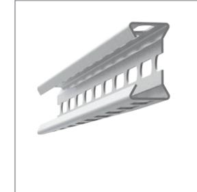
Unsere Lüftungsschiene SIGNUM LP50 aus verzinktem Stahl wird hochkant verbaut; also, seitlich offen wie ein C. Sie dient, zwischen Gewindestangen abgehängt, als Quertraverse für Lüftungskanäle in der typischen "Affenschaukel" oder als Auflage für Steigkanäle mittels Wandanbindung.
